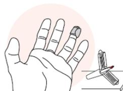
5.7. Schließen Sie die Entnahmeeinheit, indem Sie die Seiten anheben, bis sie sich oben berühren. Drücken Sie diese zusammen, bis ein Klicken zu hören ist.
